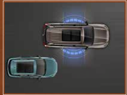
DOOR OPEN WARNING (DOW)
